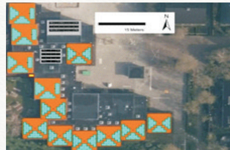
1 ste legschema zonnepanelen Prins Bernhardschool
